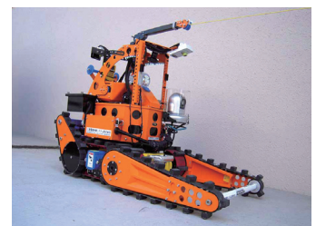
原子力発電所災害対策用に改良されたFRIGO-MA
