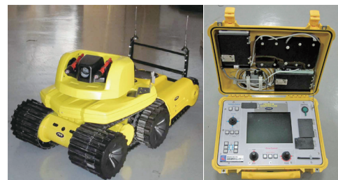
消防用偵察ロボットFRIGO-M本体 (左) と操縦装置 (右)
